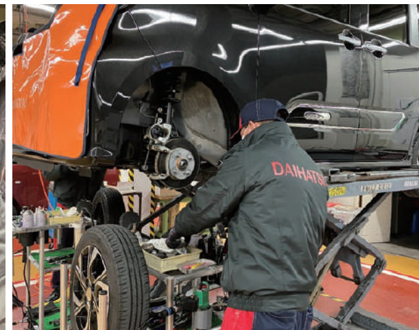
Ảnh chụp: Bên trái: Hình ảnh thực hiện tháo lắp định vị ô tô Bên phải: Hình ảnh kiểm tra định kỳ xe ô tô 1 năm theo quy định của pháp luật (Ảnh bên trái và bên phải: Tại Trung tâm Kỹ thuật Hiroshima)
